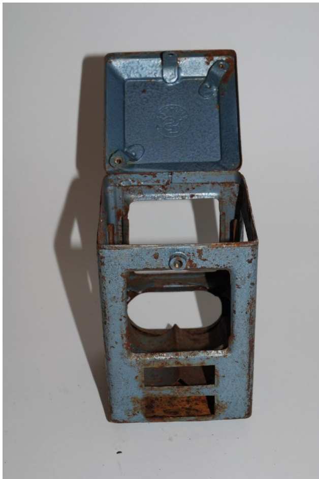
Željeznička svjetiljka - stanje kućišta nakon rastavljanja
