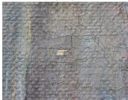
sl. 4 Detalj bojanog sloja nakon podljepljivanja
