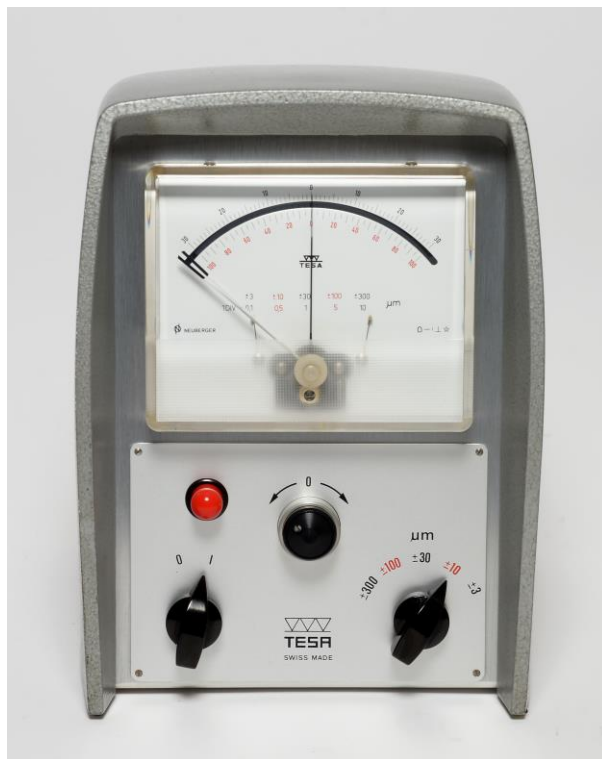
Instrument za mjerenje debljine i ravnine TESA, TMNT 10640
