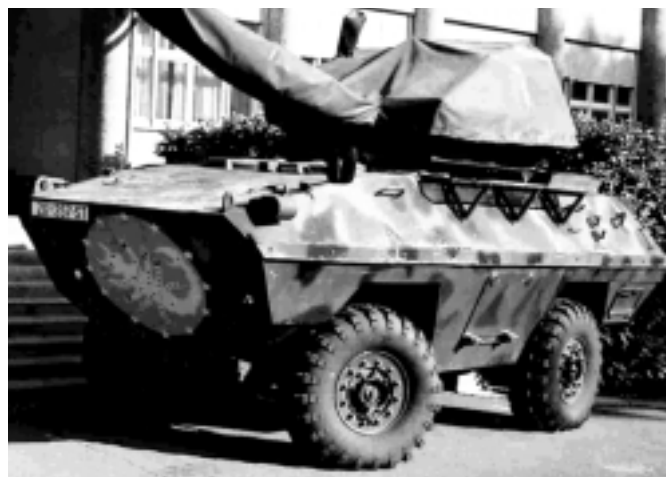
Oklopno vozilo TAM, B9/3 VP 30 (inv. br. 407), samohodno vozilo s tri cijevi promjera 20 mm.
